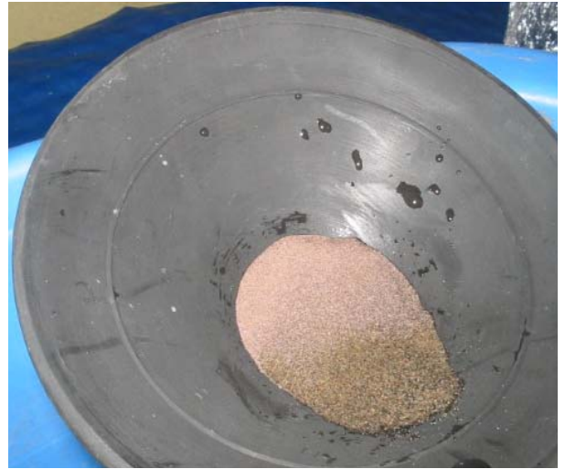
Foto 6. Vista del producto no magnético obtenido en la concentración de alta intensidad del concentrado gravimétrico primario; se observa alto contenido de circón.
