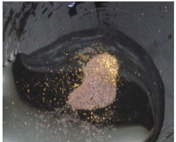
Foto 7. Vista del producto no magnético de la foto 6, luego de una rápida concentración magnética manual (en el plato) se observa alto contenido de oro libre de granulometría gruesa.
