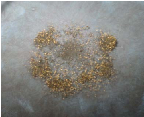
Foto 10. Vista del concentrado de oro fino obtenido mediante la flotación convencional del concentrado enriquecido magnéticamente.
