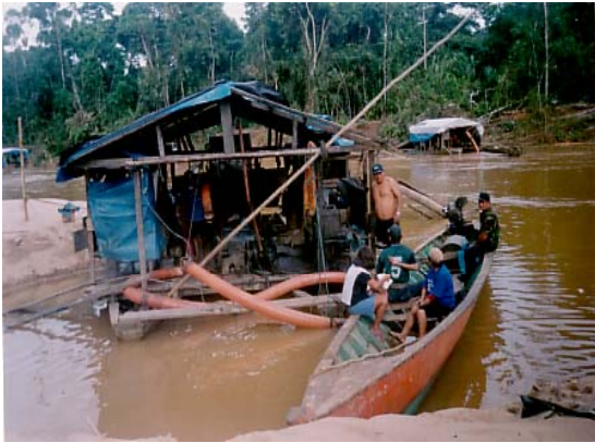
Foto 4. Operación aurífera artesanal en la Selva, método de Balsa (Succión y bombeo)
