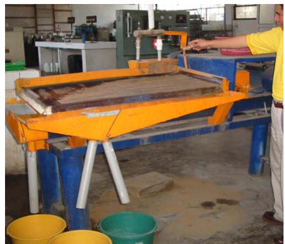
Foto 8. Vista de una mesa vibratoria para la concentración gravimétrica rápida del oro libre de granulometría gruesa. El tamaño del equipo necesario es mucho menor en nuestro caso.
