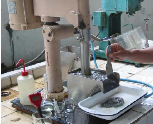
Foto 9. Vista de una celda de flotación de laboratorio para la recuperación rápida del oro libre de granulometría fina. El tamaño del equipo necesario es similar en nuestro caso.
