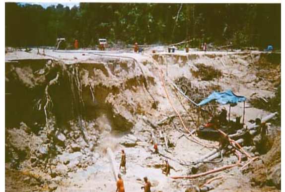
Foto .3 Operación aurífera artesanal en la Selva, método de Chupadera (Monitores y bombas)
